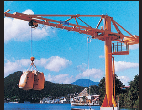
ジブクレーン
