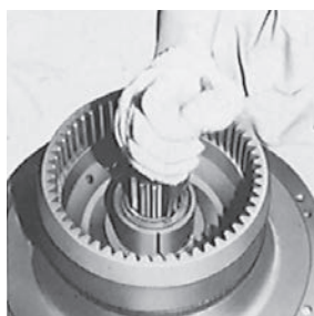
6. スナップリングを外し第4・5ギヤを外す。
