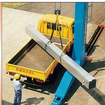
ホイスト&クレーンガーダ 横行の寄りが良く、安定した幅広横行装置
