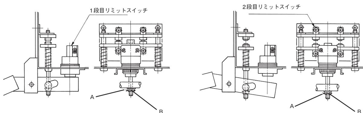
まず点検台にホイストを移動し、電源を必ず切ります。作動した原因を調査しその原因を取り除いて割りピンA、ナットBをはずして接点を復帰させます。寸動運転で注意しながらフックブロックを下げた後にナット、割りピンを元の状態にしてください。
