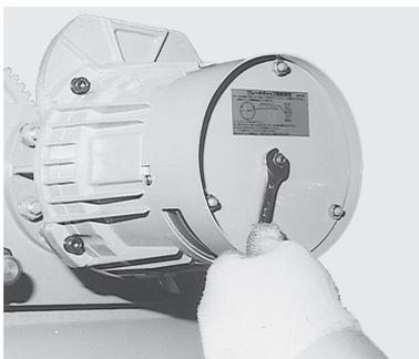
ロックナットを締め付け、ブレーキカバーを
