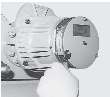
固定板の取り付けは、可動鉄心に平行
