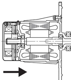
電源が切れると同時にマグネットは無励磁になり吸引力がなくなり、バネの力により可動鉄心は押されライニングを圧接して制動を行います。
