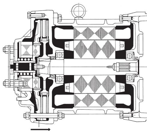
電流を切ると同時にマグネット（固定鉄心）は無励磁となり吸引力がなくなる。バネの力で可動鉄心は押されライニングを圧接し制動する。
