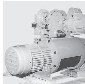
カバーを外し、すき間ゲージ0.7mmを可動鉄心と固定鉄心の間にに入れてギャップを測定してください。ギャップ許容範囲は0.2～0.7mmです。
