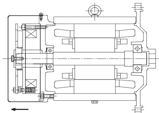
電源が切れると同時にマグネットは無励磁になり吸引力がなくなり、バネの力により可動鉄心は押しされライニングを圧接して制動を行います。
