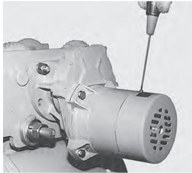
カバーを取り付けて、ギャップ・可動部分・ブレーキの効き具合・その他に異常がないか確認する。
