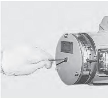
ボルトがロックしたら左（反時計回転）方向に1/2～3/4回転戻す。これで適正ギャップ0.5mm～0.8mmになる。
