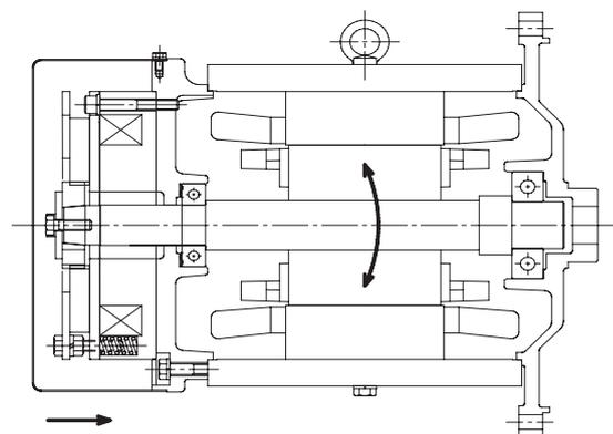
電源を電動機に入ると同時にマグネットが励磁され、可動鉄心はバネに逆らって吸引されます。この吸引で制動が開放され回転します。
