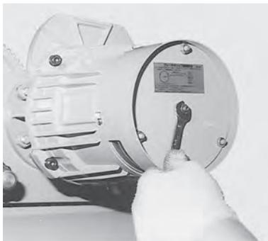
ロックナットを締め付け、ブレーキカバーを取り付ける。電源を入れ、ギャップ・可動部分・ブレーキの効き具合・その他に異常がないか確認する。
