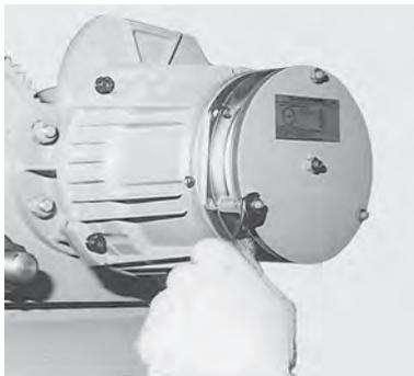
固定板の取り付けは、可動鉄心に平行になるようにナットを締め付ける。
