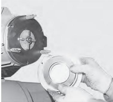
固定鉄心、可動鉄心ははずす。このときバネが落ちないように注意する。
