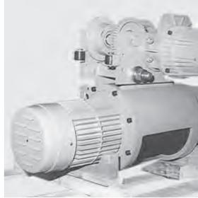
カバーを外し、すき間ゲージ 0.7mm を可動鉄心と固定鉄心の間に入れてギャップを測定してください。ギャップ許容範囲は 0.2～0.7mm です。
