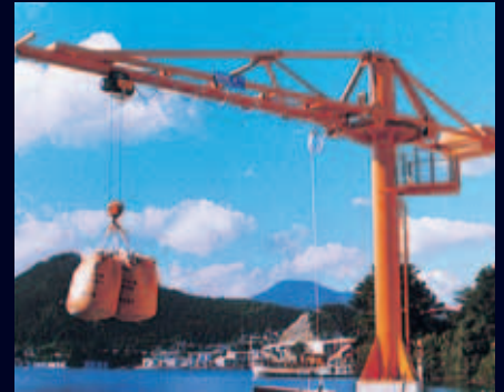
ジブクレーン
