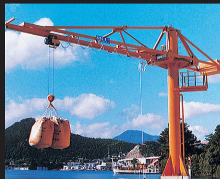
ジブクレーン
