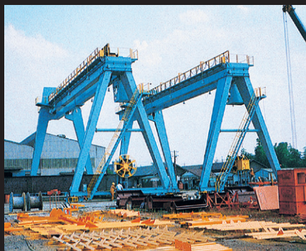
橋形クレーン
