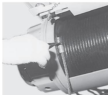
・ワイヤロープに撚りが残らないように延ばし、端末金具をワイヤドラム両端の溝にはめ、六角穴付ボルトを取り付ける。
