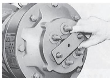
4. 調整ネジ溝と回り止めレバーが合う位置を選び、その位置のナットをはずす。
