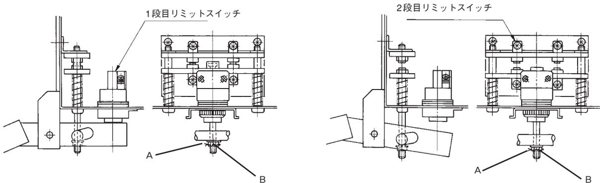
まず点検台にホイストを移動し、電源を必ず切ります。作動した原因を調査しその原因を取り除いて割りピンA、ナットBをはずして接点を復帰させます。寸動運転で注意しながらフックブロックを下げた後にナット、割りピンを元の状態にしてください。
