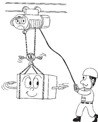
⑥緊急時の動力遮断位置を確認しておいてください。
