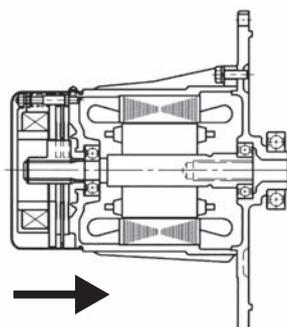
電源が切れると同時にマグネットは無励磁になり吸引力がなくなり、バネの力により可動鉄心は押されライニングを圧接して制動を行います。
