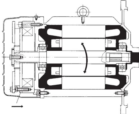
電源を電動機に入れると同時にマグネットが励磁され、可動鉄心はバネに逆って吸引されます。この吸引で制動が開放され回転します。
