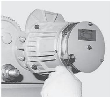
ブレーキカバーをはずし、固定板を止めているナットをはずして固定板をとる。
