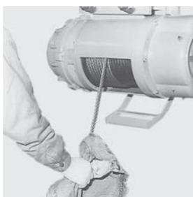
・ワイヤロープをボロ布等でつかみ、張力をかけて3～4回巻き込みます。他端はフックブロックに通します。
