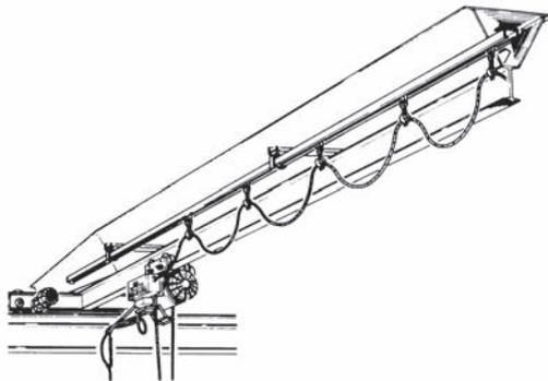
レールは軽量溝形鋼(亜鉛メッキもあります)を使用するため、長尺で接続部が少なく、ハンガーで支持します。なお、ジョイント部の2本のレールは平滑に仕上げてください。
