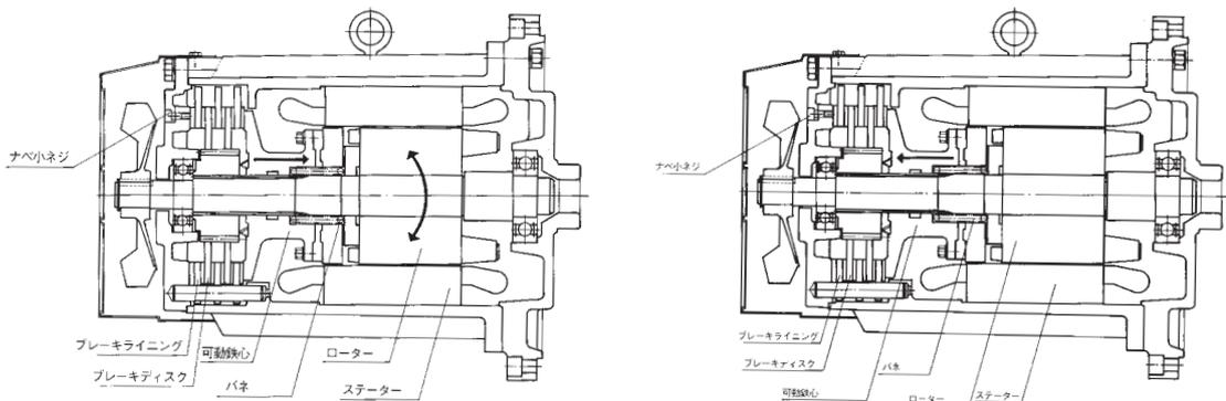
電源を入れると磁束で可動鉄心が矢印方向に吸引（ブレーキ開放）されつつ回転します。
