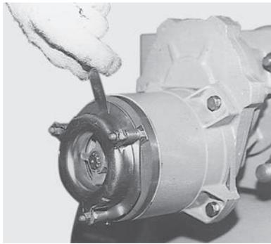
固定鉄心を取り付け、ギャップを0.4mm～0.6mmに調整する。
