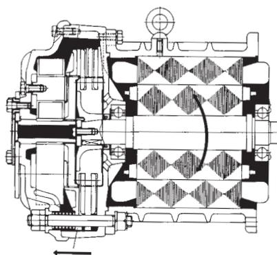
電動機に電流を通じると同時にマグネット（固定鉄心）は励磁され、可動鉄心はバネに逆らって吸引され制動が解放され電動機は回転する。
