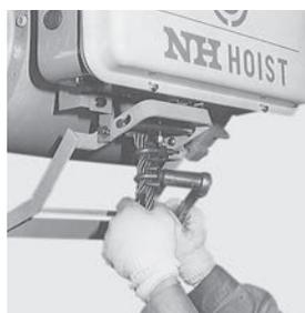
・スペースパイプを最上部にしてワイヤグリップ2ヶをトルクレンチで締めつける。ワイヤグリップの間隔はワイヤロープ径の約6倍とする。
