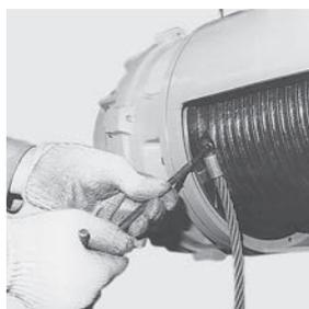
・新しいワイヤロープに撚りを残さないように延ばし、端末金具を溝にはめ六角穴付ボルトを取りつける。
