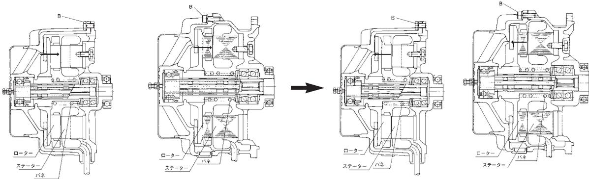
電源を入れると磁束のためにローターがステーター側に吸引されつつ（ブレーキ開放）回転します。
