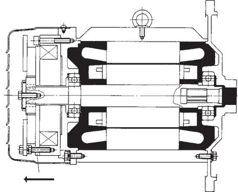
電源が切れると同時にマグネットは無励磁になり吸引力がなくなり、バネの力により可動鉄心は押されライニングを圧接して制動を行います。
