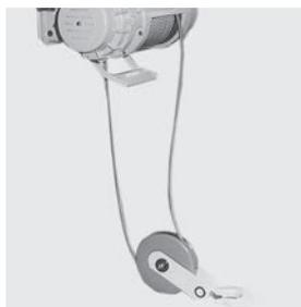
・フックブロックを床上等に降ろし、ワイヤクリップをはずす。このときスペースパイプを落とさないようにする。
