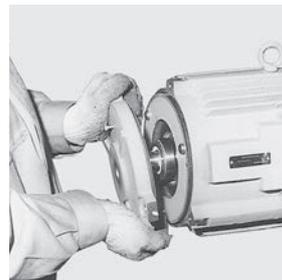
・ ギャップ調整板、ライニング、ブレーキディスクをはずし、ライニング、ブレーキディスクを交換する。
