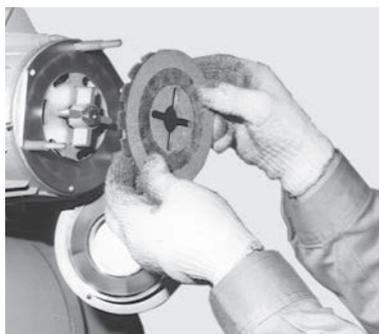
可動鉄心、バネ、固定鉄心の順に組み、固定板についている六角穴付ボルトを1回転左（反時計）方向に戻して取り付ける。
