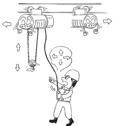
**警告** ● 使用前に押ボタンの動作を確認し、押ボタンが円滑に動作しない時は運転しないでください。
