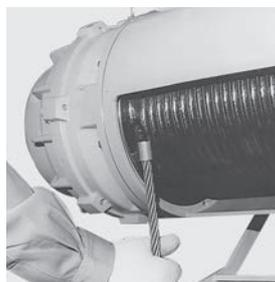
・ワイヤロープ取付部までゆっくり引き出す。六角穴付ボルトを取りはずし、端末金具を上方に抜く。
