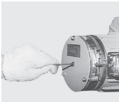
ボルトがロックしたら左（反時計回転）方向に1/2～3/4回転戻す。これで適正ギャップ0.5mm～0.8mmになる。
