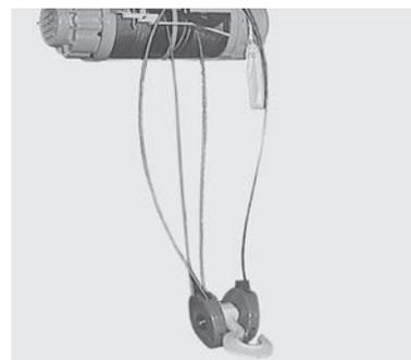
・フックブロックを床上に降ろし、ワイヤロープを引き出す。取付部近くは逆巻きをさけるためにゆっくり引き出し、六角穴付ボルトをはずしてワイヤロープを取りはずす。
