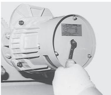
ロックナットを締め付け、ブレーキカバーを取り付ける。電源を入れ、ギャップ・可動部分・ブレーキの効き具合・その他に異常がないか確認する。
