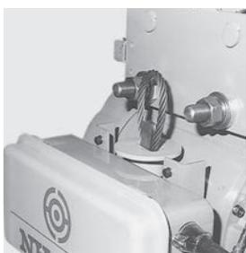
・ワイヤロープをウェッジソケットの下から上へ通し、再び下へ通します。ワイヤロープがドラムケースの下端より190～200mm出るようにする。ワイヤウェッジを入れ300kg程度の荷重を吊ってワイヤロープ、ワイヤウェッジ、ウェッジソケットが密着するようにする。
