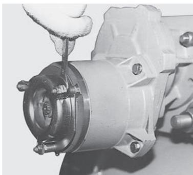
ギャップが1mm以上のときにはナットを緩めて調整する。このときのギャップ調整は0.4mm～0.6mmにする。
