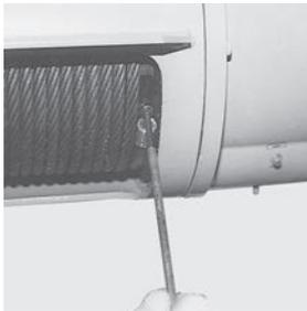
・ワイヤロープに撚りが残らないように延ばし、端末金具溝にはめて六角穴付ボルトを取りつける。
