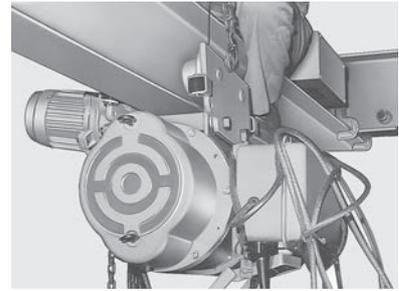
ロープを締付けていきますと、プレーン側のみつり揚がり I 形鋼へはまり込みます。取り付けナットを締付けて下さい。
