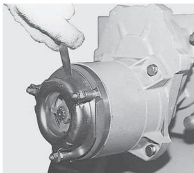
ブレーキカバーをはずし、固定鉄心と可動鉄心の間にスキマゲージ1mmを入れギャップを測定する。
