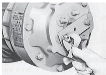
5. (1)ではずしたナットをはめ、(4)ではずしたナットで回り止めレバーを固定する。
