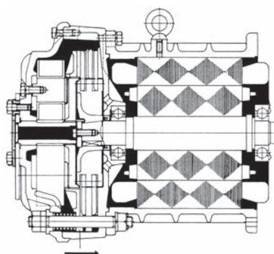
電流を切ると同時にマグネット（固定鉄心）は無励磁となり吸引力がなくなる。バネの力で可動鉄心は押しされライニングを圧接し制動する。
