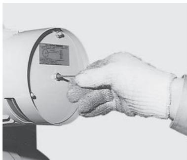
ボルトがロックしたら左（反時計回転）方向に $\frac{1}{2}$ ～ $\frac{3}{4}$ 回転戻す。これで適正ギャップ0.5mm～0.8mmになる。
