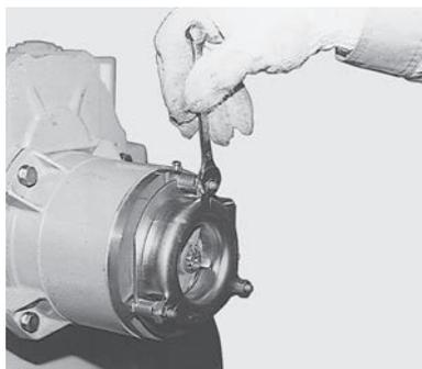
カバーをはずしナットを取り、固定鉄心、可動鉄心、バネをはずす。
