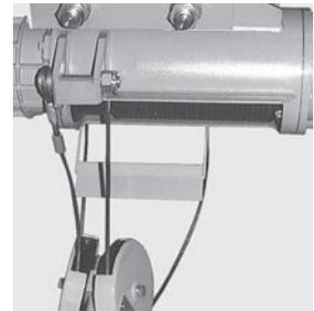
・フックブロックを取り付け、定格荷重をゆっくりとつり取付各部に異常がないことを確認する。
