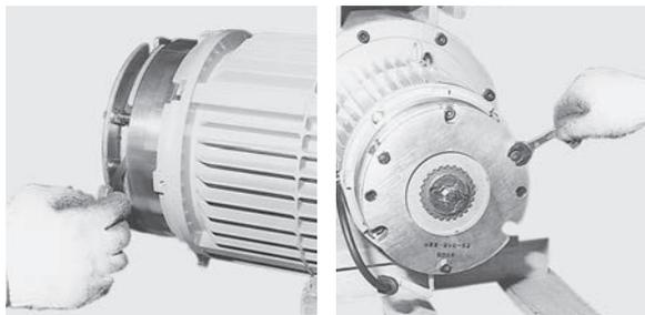
カバーを外し、すき間ゲージ0.7mmを可動鉄心と固定鉄心の間にに入れてギャップを測定してください。ギャップ許容範囲は0.2～0.7mmです。
