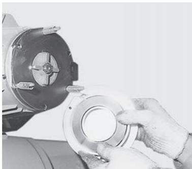
固定鉄心、可動鉄心をははずす。このときバネが落ちないように注意する。
