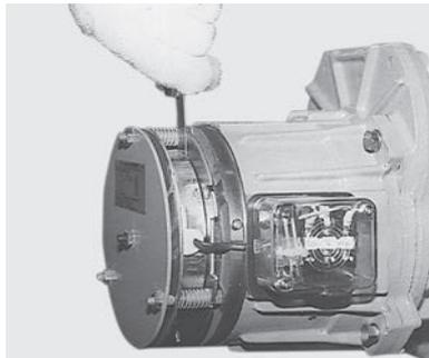
ブレーキカバーをはずし、固定鉄心と可動鉄心の間にスキマゲージ1mmを入れギャップを測定する。
