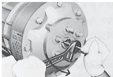
2. 回り止めレバーを利用して調整ネジを左(反時計回り)にいっぱい回す。この状態でギャップはゼロとなる。
