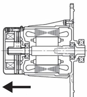
電源を電動機に入れると同時にマグネットが励磁され、可動鉄心はバネに逆らって吸引されます。この吸引で制動が開放され回転します。
