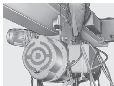
ロープを締付けていきますと、プレーン側のみつり揚げり I 形鋼へはまり込みます。取り付けナットを締付けて下さい。
