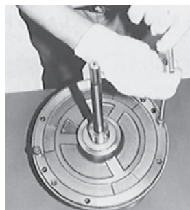
3. 皿小ネジをはずし、ギヤケースカバーをはずす。
