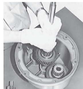
8. 連結軸をはずし、連結軸から第4・5ギヤを抜く。
