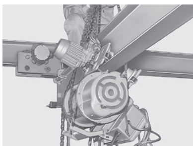
ギヤ側を I 形鋼へはめ込みます。
