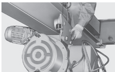
次に横行車が I 形鋼幅に少し余裕を持って取付けられたかよく点検し、取付けナットを充分締付けます。
