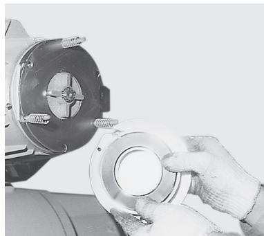
固定鉄心、可動鉄心をはずす。このときバネが落ちないように注意する。
