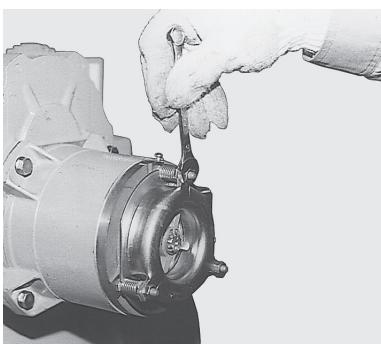
カバーをはずしナットを取り、固定鉄心、可動鉄心、バネをはずす。
