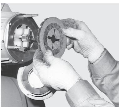
可動鉄心、バネ、固定鉄心の順に組み、固定板についている六角穴付ボルトを1回転左（反時計）方向に戻して取り付ける。
