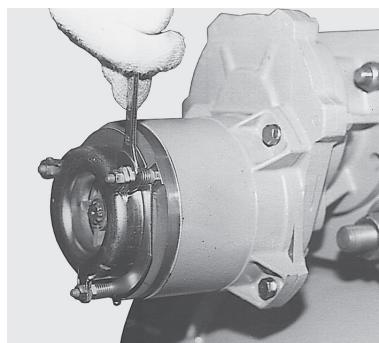
ギャップが1mm以上のときはナットを緩めて調整する。このときのギャップ調整は0.4mm～0.6mmにする。
