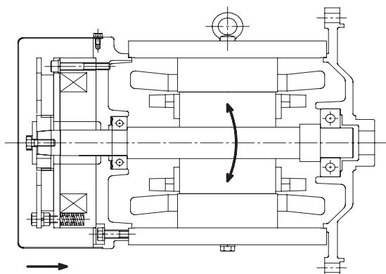
電源を電動機に入れると同時にマグネットが励磁され、可動鉄心はバネに逆らって吸引されます。この吸引で制動が開放され回転します。
