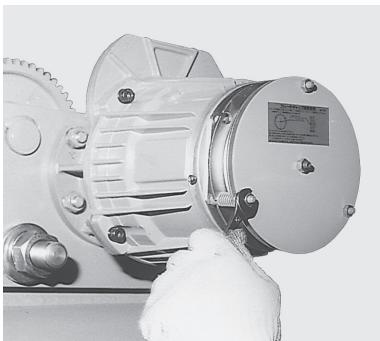
ブレーキカバーをはずし、固定板を止めているナットをはずして固定板をとる。
