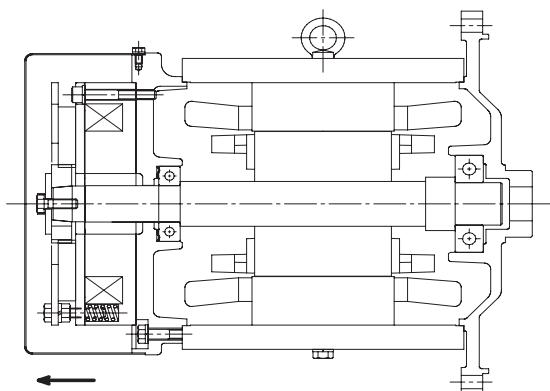
電源が切れると同時にマグネットは無励磁になり吸引力がなくなり、バネの力により可動鉄心は押されライニングを圧接して制動を行います。
